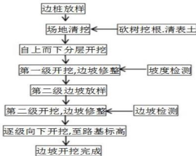
图 2.9.1-2 路基边坡施工工艺流程
