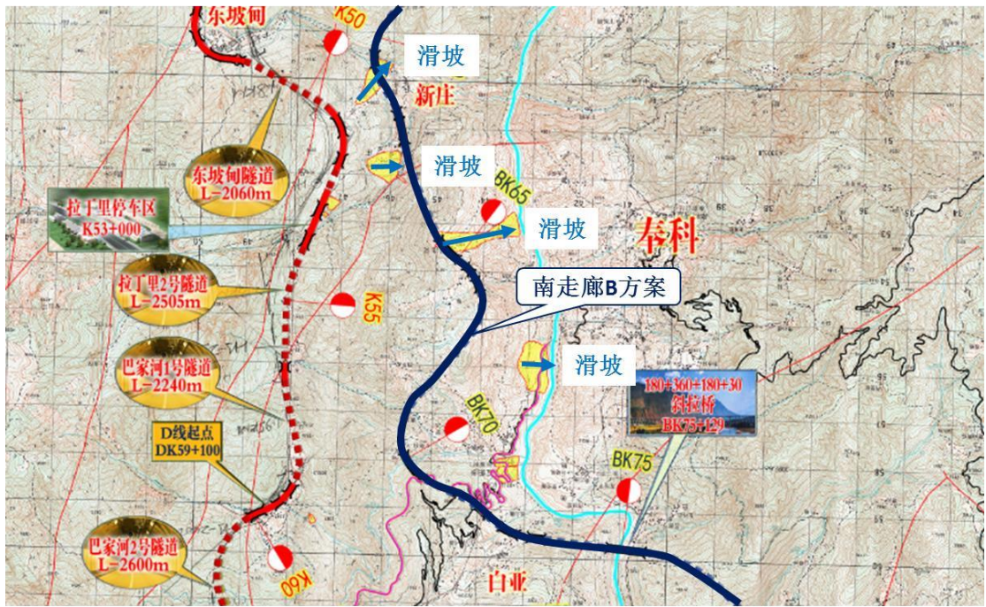
图 8.1.3-3 南走廊 B 方案地质条件示意图
