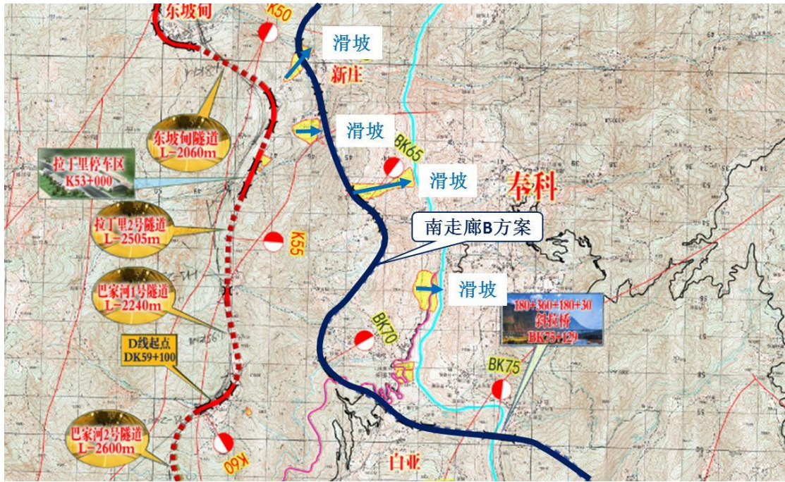
图 8.1.3-3 南走廊 B 方案地质条件示意图
